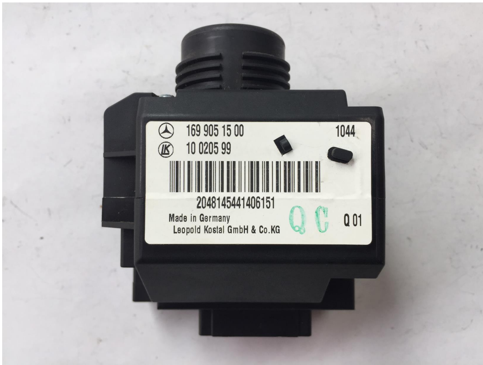
2.车辆熄火，拆取锁头模块，查看外观样式和芯片
